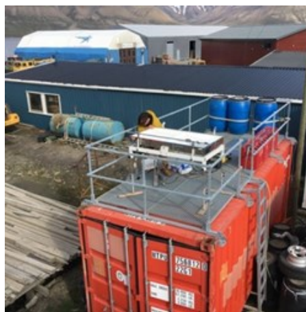
Na střeše technického kontejneru testujeme otevřený fotobioreaktor při kultivaci řas. On technical container's roof we test open photobioreactor for cultivation of microalgae.
